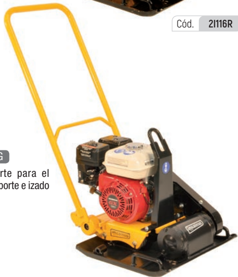
Grupo vibrante integrado en la placa base Máxima fiabilidad y mínimo mantenimiento.
