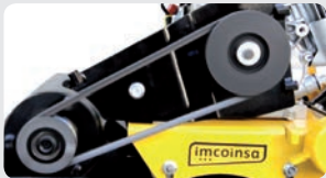
Polea excéntrica Ahorro en costes de mantenimiento. Mayor vida útil de las correas.
